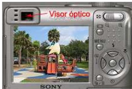
*El visor óptico es impreciso y se encuentra limitado a diferencia del monitor LCD. El visor óptico sólo se utiliza cuando las condiciones de iluminación son escasas e impiden que el monitor LCD realice bien la lectura de la imagen o en el caso de que se encuentren las pilas agotadas.*
